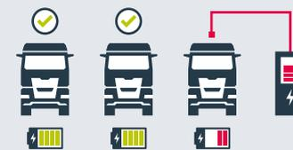
**Lkw 1 ist voll geladen, Lkw 2 wird als einziger geladen** – 100 % der verfügbaren Leistung wird von Lkw 2 verbraucht
