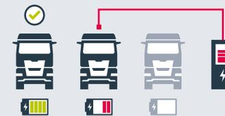
**Lkw 1 und 2 sind jetzt gleichzeitig angeschlossen** – die verfügbare Leistung wird gleichmäßig aufgeteilt: jeweils 50 %
