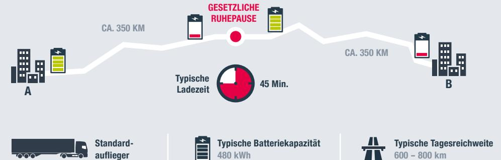
Das Megawatt-Ladesystem ist der Wegbereiter für den Fernverkehr. Mit einer Ladeleistung von bis zu 1.000 kW lässt sich ein typischer Elektro-Lkw innerhalb von 45 Minuten vollständig aufladen. Unter Berücksichtigung der gesetzlichen Einschränkungen der Lenkzeiten können 2 Fahrschichten von je 400 km an einem normalen Arbeitstag mit einer einzigen Ruhepause erreicht werden.
