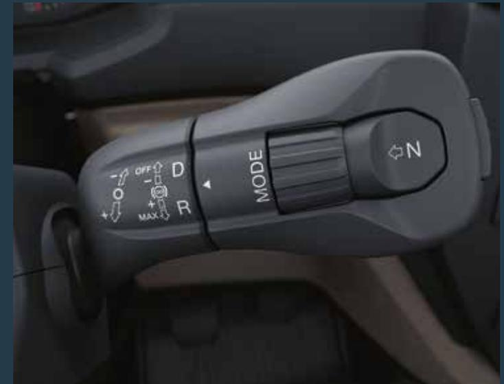
Vollständig neu entwickelt wurde die Getriebebedienung am rechten Lenkstock. Sowohl Fahrbereich als auch Fahrprogramm werden am Lenkstockschalter gewählt. Die Bedienung erfolgt griffgünstig und bediensicher in unmittelbarer Nähe des Lenkrads und der elektrischen Feststellbremse.
