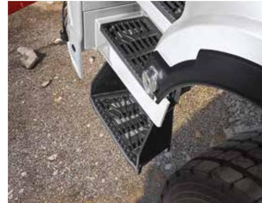
Die bei Geländefahrten beschädigungsanfällige untere Trittstufe ist jetzt mit einer Pendelfunktion ausgestattet. Die Befestigungslaschen sind aus elastischem Kunststoff – so können sie sich bei Bodenkontakt verformen und anschließend in ihre Ursprungsform zurückkehren.
