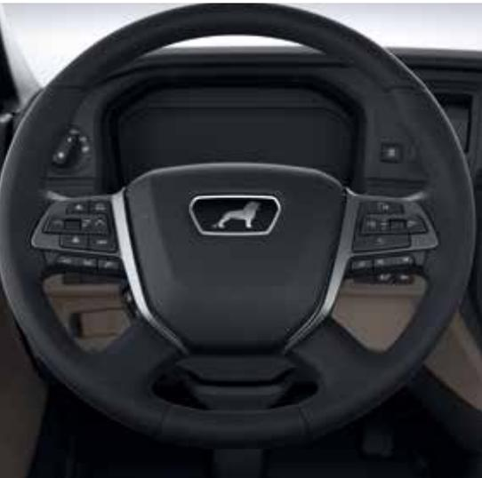
Als ergänzendes Rückhaltesystem kann der im Multifunktionslenkrad integrierte Fahrerairbag zusammen mit dem Sicherheitsgurt und dem Gurtstraffer bei einem Unfall das Verletzungsrisiko beziehungsweise die Schwere der Verletzung des Fahrers reduzieren. Der 70-l-Airbag und der Gurtstraffer am Fahrersitz werden bei einem Aufprall durch ein gemeinsames Steuergerät aktiviert und die Treibsätze gleichzeitig gezündet.
