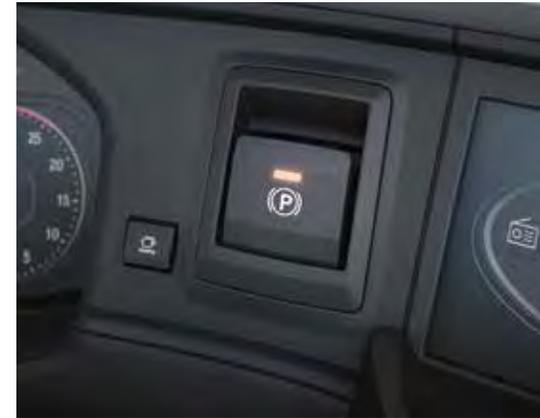
Die neue elektrische Feststellbremse kann optional über einen Schalter bedient werden, der rechts neben dem Hauptdisplay in der Instrumententafel angeordnet ist. Sowohl das Betätigen der Feststellbremse beim Abstellen des Fahrzeugs als auch das Lösen beim Losfahren kann unter bestimmten Bedingungen auch automatisch erfolgen.
