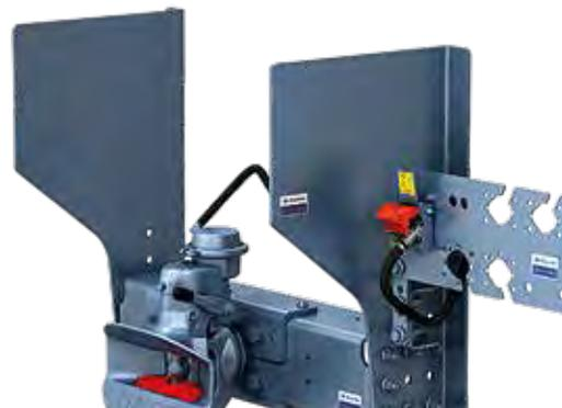
Tiefkuppelbock mit Anhängerkupplung (mit pneumatischer Öffnung). Rücksprungmaß 1 400 mm (Standard) und 1 600 mm (Volumen). Brems- und Elektroanschlüsse je nach Wunsch fahrer- oder beifahrerseitig hinter der Nachlaufachse.
