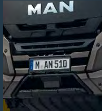
Stahlstoßfänger mit mittig angeordnetem Schleppmaul hinter Kfz-Kennzeichen und klappbarem Frontaufstieg.
