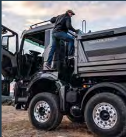
Bauaufstieg mit Haltereling auf dem Dach.
