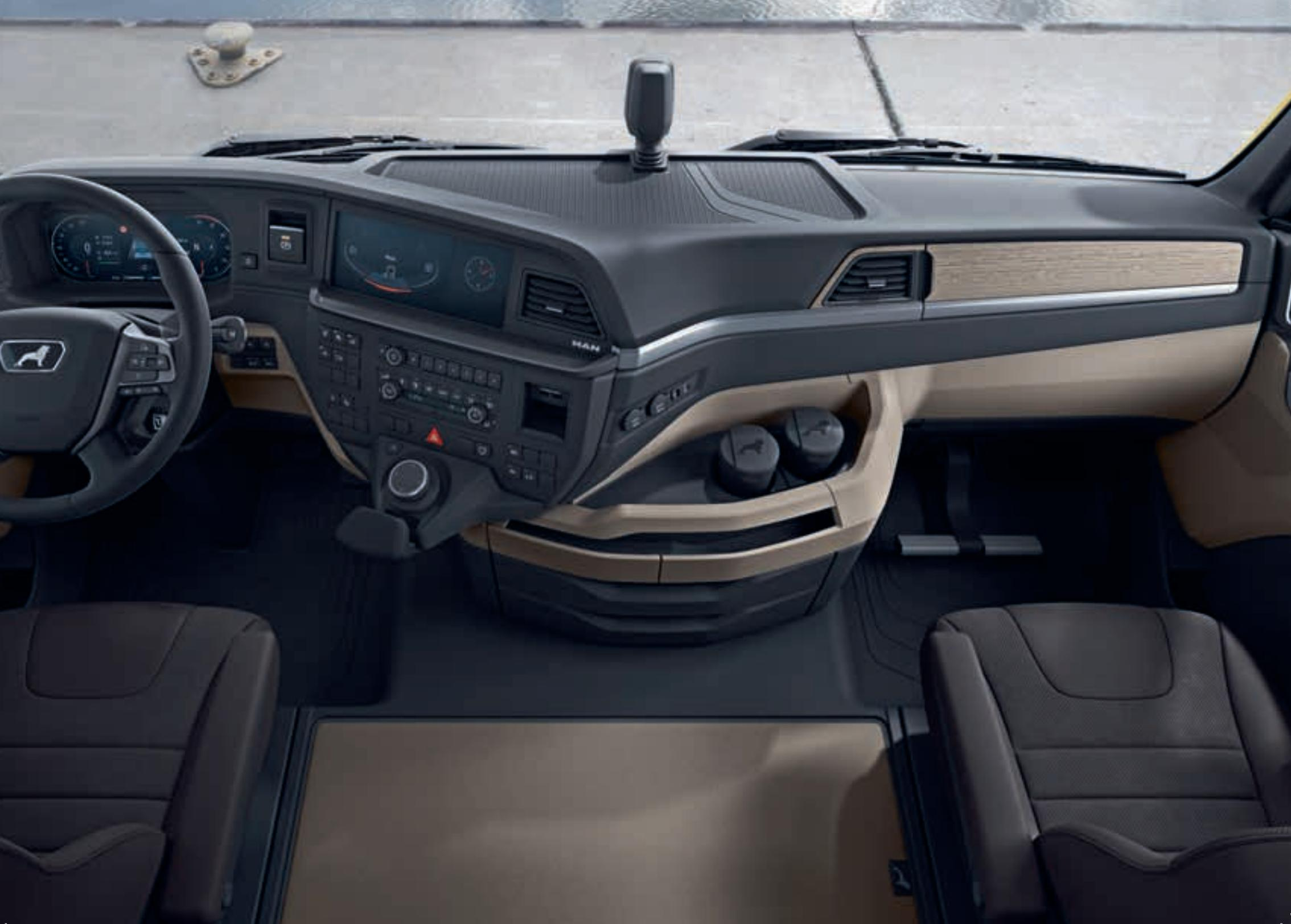
Zentral im Blickfeld des Fahrers: rein digital dargestelltes Kombiinstrument für die Anzeige von Fahrdaten, Assistenzsystemen, Warn- und Hinweisinformationen u.Ä. Seitlich: Sekundärdisplay für die Navigation durch das Infotainmentmodul.
